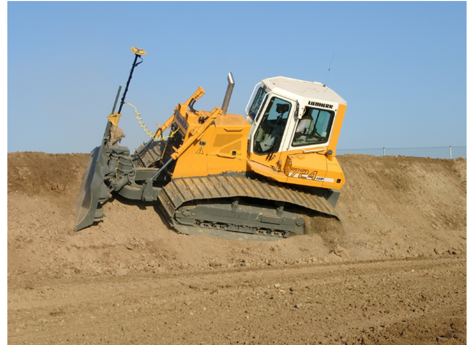
Planierraupe mit GPS-Steuerung (Bild: AFZ Walldorf)
